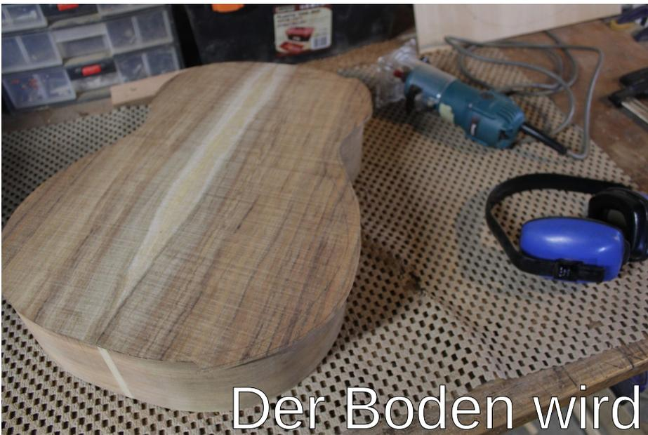
Der Boden wird auf die Zarge getrimmt
